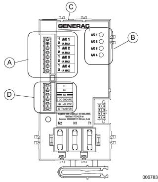
Figure 2-2. Smart A/C Module (SACM)
